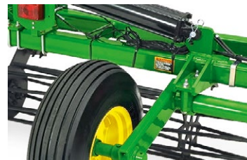
Благодаря транспортным колёсам обеспечивается возможность передвижения по дороге; при работе в поле они поднимаются, позволяя переносить вес на каток.
