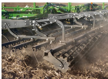
3-рядная штригельная борона с пружинным прикатывающим катком
