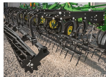
3-рядная зубовая борона с планчатым прикатывающим катком
