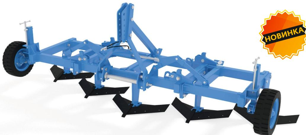
Предназначен для основной обработки паров, осенней обработки почвы с максимальным сохранением стерни и других пожнивных остатков на поверхности поля после колосовых и пропашных предшественников в целях защиты почвы от ветровой эрозии.
